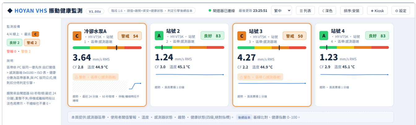
明亮主題 — 兩台落入區帶 C，卡片轉為警戒色並顯示警告來源；畫面為開發階段版本，實際顯示以出貨韌體為準
