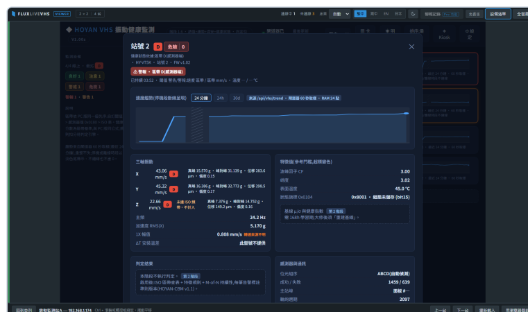
設備詳情 — 單台展開後之三軸振動明細、特徵值、趨勢與通訊統計，並標示該筆判定所依據之區帶來源與準則版本
